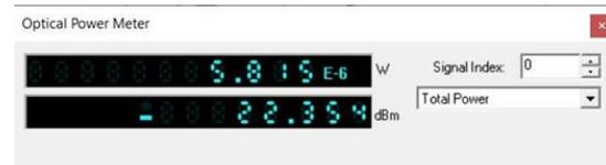
El análisis óptico espectral realizado a la salida de la red de distribución en el segundo nivel de división óptica se observa en la Gráfica 17, en este caso el sistema presenta un pico de potencia de 22,354 db.
